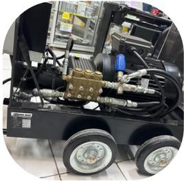
La aspiración del detergente es realizada a baja presión, a través del sistema venturi.
