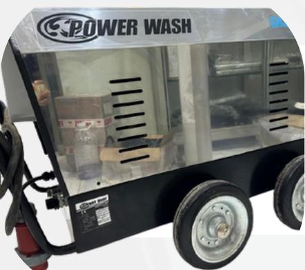
Estructura metálica, capota acero inoxidable, conjunto motor-bomba de 1450 rpm. Motor con doble rodamiento y bomba de 3 pistones en cerámica con bielas y árbol de levas.
